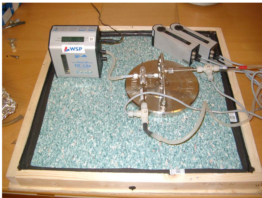
Foto på uppställning vid FLEC-mätning enligt Stansmetod.
