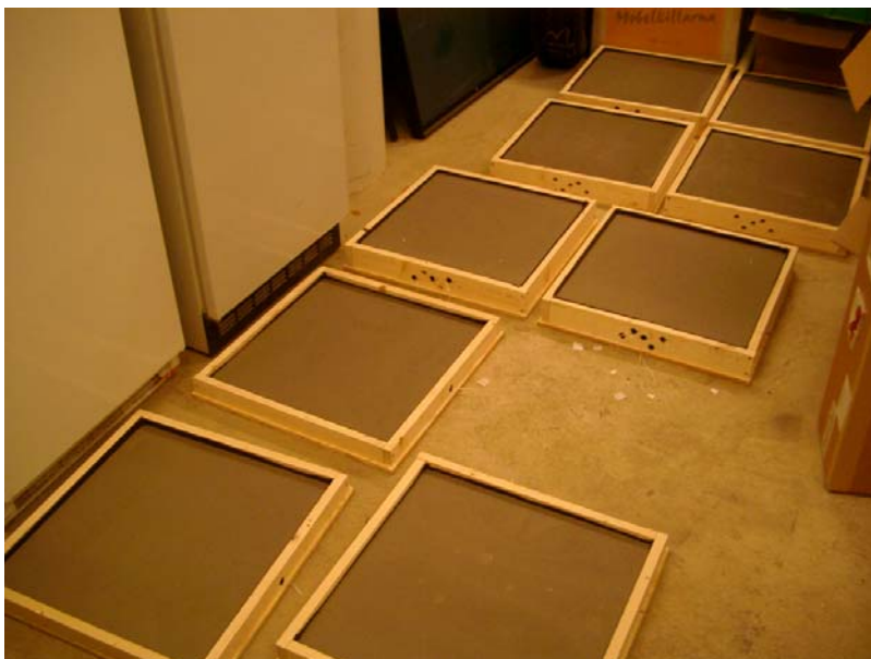
Bild: Totalt 26 st formar med dimension 0,5 *0,5 m avjämnades.
